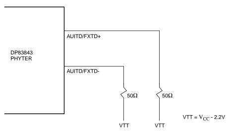
Figure 27. 100BASE-FX Test Load
