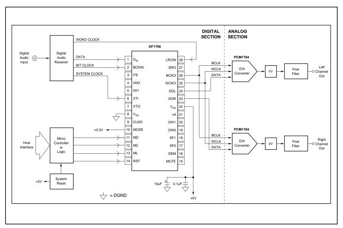
FIGURE 14. DF1706 Typical Application Circuit.
