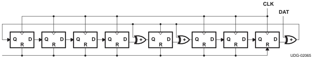
**Figure 17. 8-Bit CRC Generator Circuit ( $X^8 + X^5 + X^4 + 1$ )**
